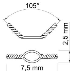
*rozměry klipového značkovače*
